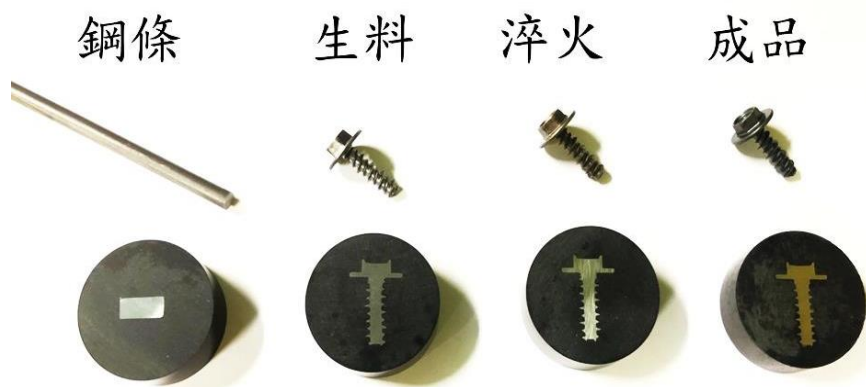
圖 3.4 上方為原料鋼線材、生料螺絲(未熱處理)、淬火熱處理螺絲、淬火與回火螺絲，下方為申請人將其切割鑲埋成實作工件
